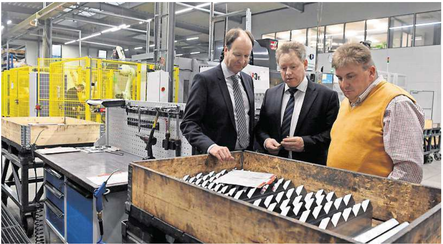
Cutmetall-Geschäftsführer Oliver Huther zeigt Henry Worm und Sven Gregor (von links) Ergebnisse der Fertigung. Solche gezahnten Messer kommen zum Beispiel in Industrieschreddern zum Einsatz. Fotos: frankphoto.de
